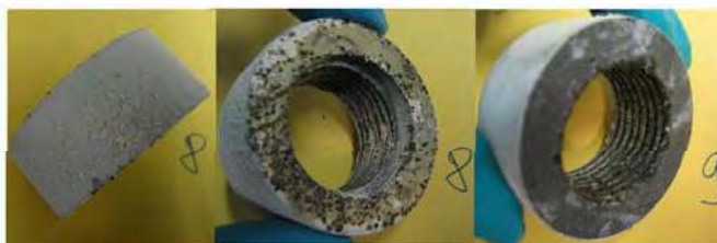
Endzustand verschiedener Proben (Edelstahl, Stahl mit Beschichtungen) nach 6 Wochen Kontakt mit Sole
