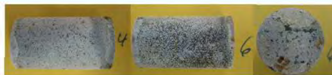
Endzustand verschiedener Proben (Edelstahl, Stahl mit Beschichtungen) nach 6 Wochen Kontakt mit Sole
