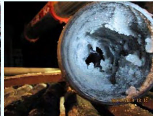
Exzentrerschnecke der Pumpe nach PV mit beginnendem Lochfrass
